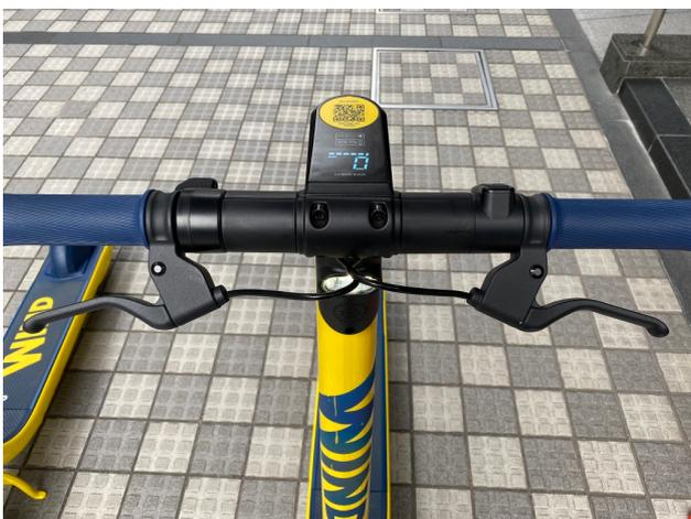
片手レバー式から両手用自転車式に改良したブレーキ
